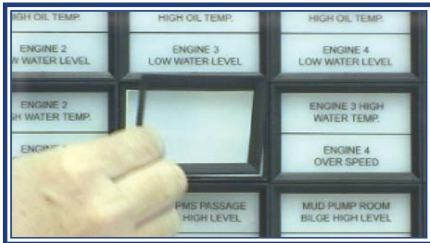
2- Remove the plastic bezel
