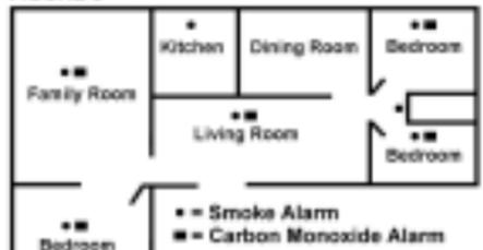
RECOMMENDED COMBO ALARM PROTECTION FOR A SINGLE-FLOOR RESIDENCE
