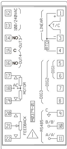
Fig. 3 REAR TERMINAL BLOCK
