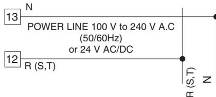
Fig. 12 POWER LINE WIRING
