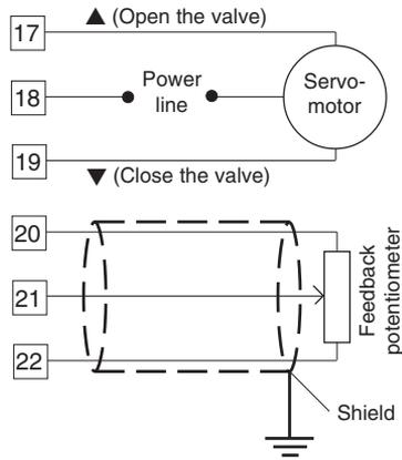
Fig. 8 - SERVOMOTOR WIRING
