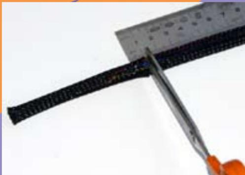
6 - Couper la gaine extérieure du câble de commande avec une pince coupante de bonne capacité
