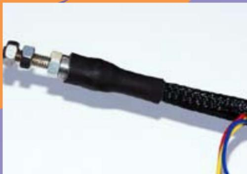
12 - Remonter le câble de commande, l'arrêt de gaine sur le moteur, couper le câble à 6 mm du serre câble, en le sortant pour le couper franchement, bloquer le serre câble en laissant un peu de jeu (3 mm).
