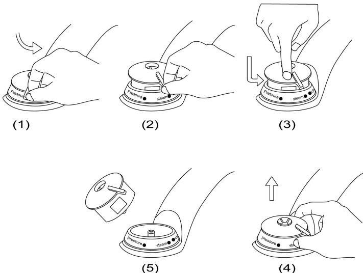
3. Déle la vuelta a la tapa y colóquela encima de una mesa. Saque la funda anti-bloqueo tirando hacia arriba. Usando un cepillo, compruebe y elimine cualquier resto de comida o de partículas extrañas que puedan estar dentro de la válvula flotante. Vuelva a poner la funda anti-bloqueo empujando hacia abajo hasta que se sujete en su posición.
