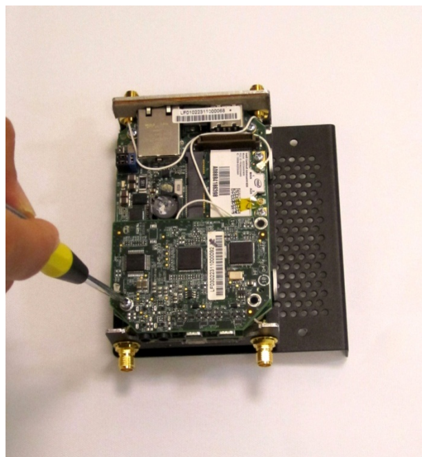
Figure 30. Holding the AV board in place
