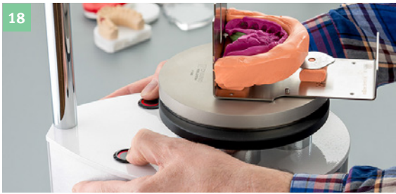
Bohrvorgang durch Knopfdruck starten – die Plattenaufnahme wird elektromagnetisch fixiert.
