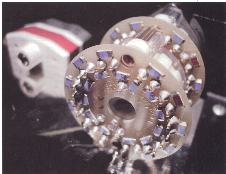
La parte interna del Pre mostra in primo piano le resistenze a strato metallico a montaggio superficiale. In secondo piano il selettore degli ingressi, anch'esso blindato. Una pulizia d'insieme eccellente.
