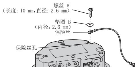
8. 将摄像机上的 2 个圆形突出部分与天花板盖板（摄像机附带）上的孔对齐，拧紧螺丝将天花板盖板固定，然后如图所示将保险丝穿过天花板盖板。确保执行该步骤时不会刮花镜头盖。
