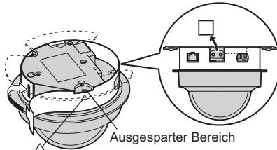
10. Befestigen Sie die Kamera mit Schraube B (Lieferumfang) an 3 Stellen an der Halterung.
