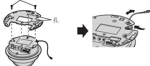
9. 安装连接器盖（附带），然后将必要的电缆连接到摄像机。
