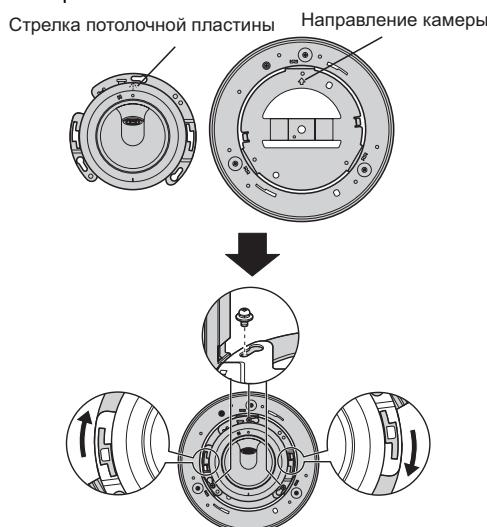
11. Прикрепите крышку для крепления к потолку (в комплекте) к кронштейну.
