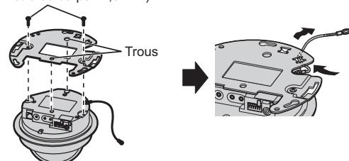
**9.** Fixez le cache du connecteur (fourni) et connectez les câbles nécessaires à la caméra.
