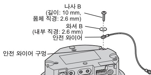
8. 카메라에 있는 두 개의 원형 돌출 부분을 천장 장착판(카메라 기본 구성품) 구멍에 맞추고 나사를 조여 천장 장착판을 고정한 다음 그림과 같이 안전 와이어가 천장 장착판을 통과하게 합니다. 이 과정에서 렌즈 커버에 스크래치가 나지 않도록 주의하십시오.
