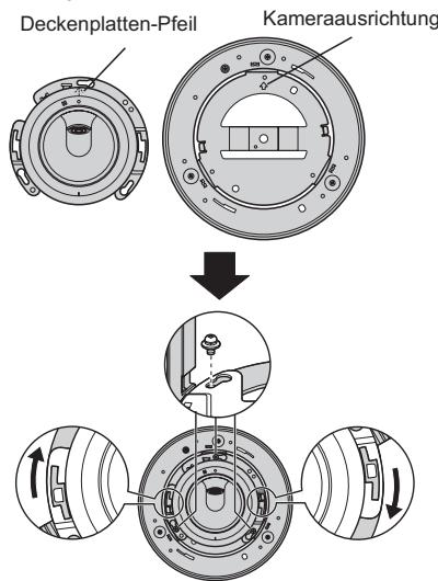
11. Befestigen Sie die Abdeckung für die Deckenbefestigung (Lieferumfang) an der Halterung.
