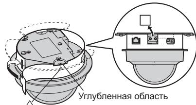
10. Прикрепите камеру к кронштейну в 3 местах с помощью винта B (в комплекте).
