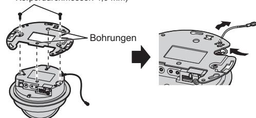
9. Befestigen Sie die Anschlussabdeckung (Lieferumfang), und schließen Sie anschließend alle erforderlichen Kabel an der Kamera an.
