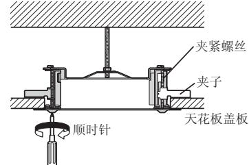
6. 将螺母（非附带）安装并拧紧到锚杆后，将支架固定。
