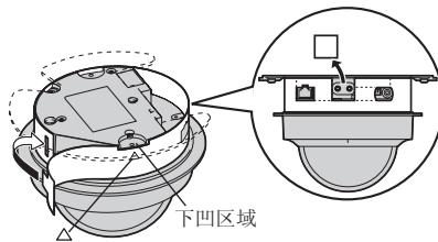
10. 用螺丝 B（附带）在 3 处将摄像机安装到支架。
