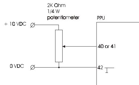
+/- 10V input using potentiometer:
