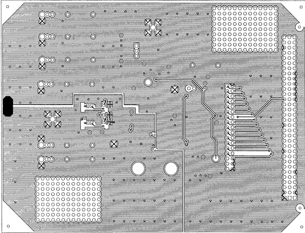
FIGURE 15. HI5905EVAL2 EVALUATION BOARD COMPONENT FAR SIDE (LAYER 4)
