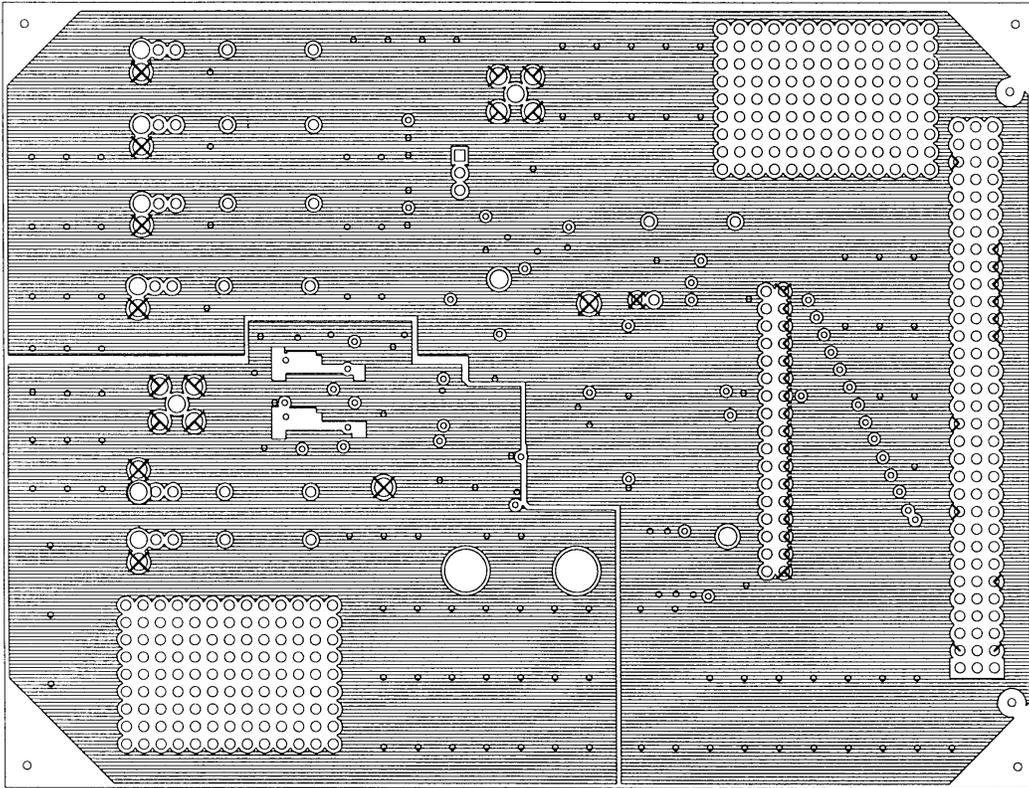
FIGURE 13. HI5905EVAL2 EVALUATION BOARD GROUND PLANE LAYER (LAYER 2)
