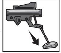
Le chariot se réenclenchera lors de la prochaine ouverture ou fermeture de la porte.
