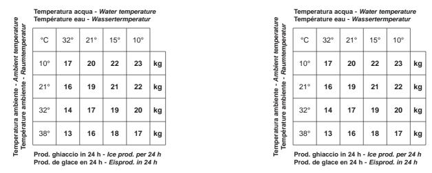
(\*) con temperatura ambiente 32 °C e con temperatura acqua 21 °C - with room temperature 32 °C and water temperature 21 °C avec température ambiente 32 °C et température eau 21 °C - mit Raumtemperature 32 °C und Wassertemperatur 21 °C
