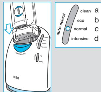
Si le système a sélectionné l'un des trois programmes de nettoyage, il ne démarrera que lorsque vous appuiez sur le bouton de démarrage du nettoyage « start cleaning » (2). Cela verrouillera le rasoir dans le chargeur et débutera le programme de nettoyage.
