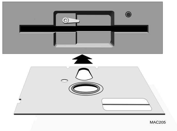
**Figure 3-4. Inserting a 5 1/4" Diskette**
