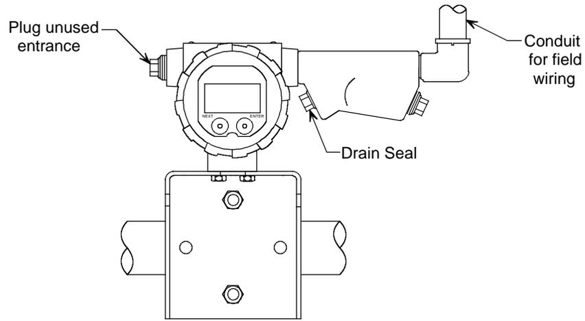
Conduit Drain Installation
