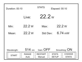
Figure 23. STATS: Statistics Readout
