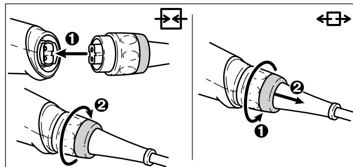
**ADVERTENCIA** Apague siempre la máquina antes de conectar o sacar el cable de conexión a la red.
