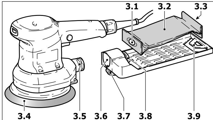
Las máquinas están equipadas como equipo de serie con un dispositivo autoaspirador. El polvo de lijado es aspirado por las aberturas de aspiración que se encuentran en el plato de lijado (3.4) y es recogido en el turbofiltro (3.2).
