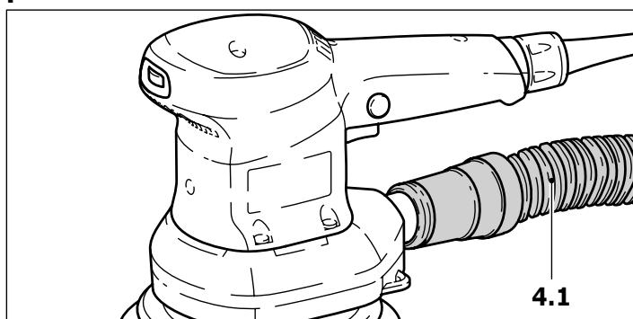
A fin de evitar un frecuente cambio del turbofiltro durante trabajos de lijado relativamente largos, en lugar del dispositivo autoaspirador se puede conectar un aspirador Festool.
