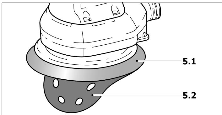
Los materiales abrasivos autoadheribles (5.2) se presionan simplemente sobre el plato de lijado (5.1) y son retenidos con seguridad por el recubrimiento adherente del plato de lijado Stickfix.
