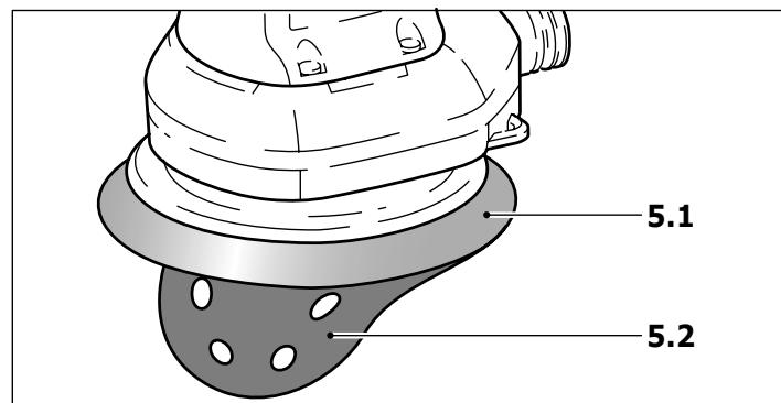
Les abrasifs autoagrippant (5.2) sont facilement placés sur le patin de ponçage (5.1) puis maintenus en toute sécurité par le revêtement autoagrippant du patin de ponçage Stickfix.
