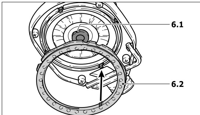
Le patin de ponçage est bloqué par une collerette (6.2) afin d'éviter qu'il ne monte de façon incontrôlée. La collerette étant soumise à l'usure dans le temps, l'effet de blocage s'affaiblit, et elle doit être remplacée par une neuve (453388).
