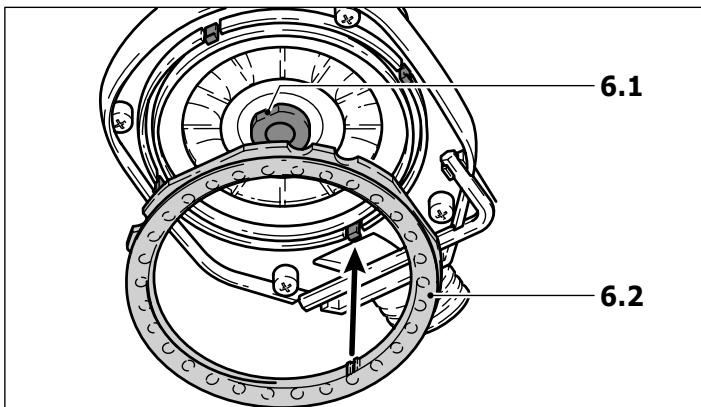
A fin de evitar una aceleración incontrolada del plato de lijado, ésta es frenada por medio de una guarnición (6.2). Debido a que esta guarnición se desgasta con el tiempo, ésta tiene que ser renovada cuando se registre una merma en el efecto de frenado (453388).
