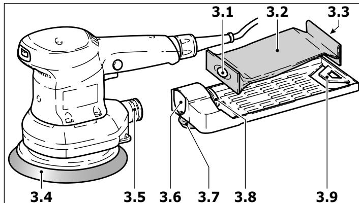
Les machines sont équipées en série d'un dispositif d'auto-aspiration. La poussière de ponçage est aspirée à travers les orifices d'aspiration du patin de ponçage (3.4) puis collectée dans le filtre turbo (3.2).
