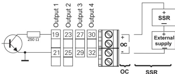
**b) Transistor outputs of OC type**
