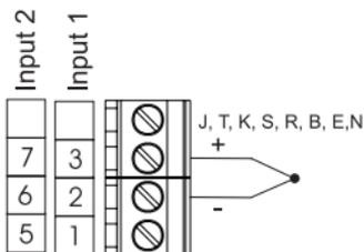
**c) Thermocouple inputs**
