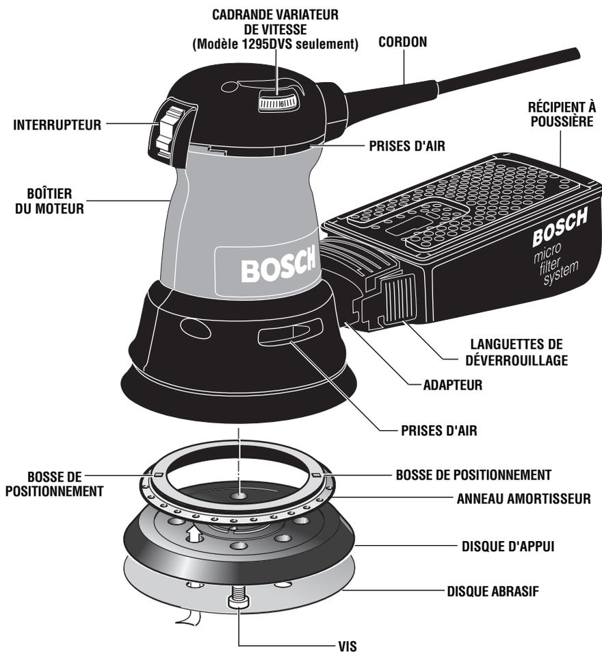
**⚠ MISE EN GARDE** Pour éviter de faire des traces sur la surface, ne démarrez pas l'outil lorsqu'il est posé sur la pièce. Laissez-le toujours tourner pendant au moins une minute avant de l'utiliser pour lui permettre d'atteindre le plein régime.
