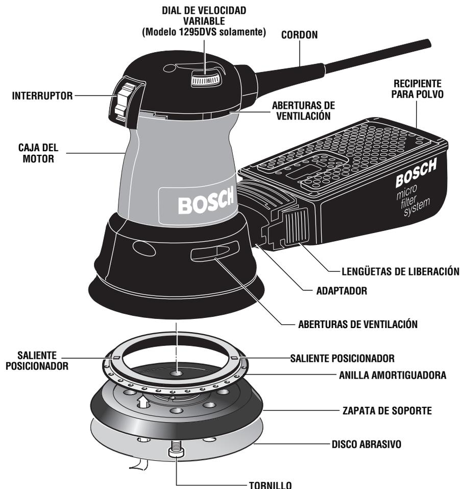
**PRECAUCION** Para evitar posibles marcas de remolino, no arranque la herramienta sobre la pieza de trabajo. Haga funcionar siempre la herramienta durante al menos un minuto antes de realizar la operación. Esto permite que la herramienta alcance toda su velocidad.
