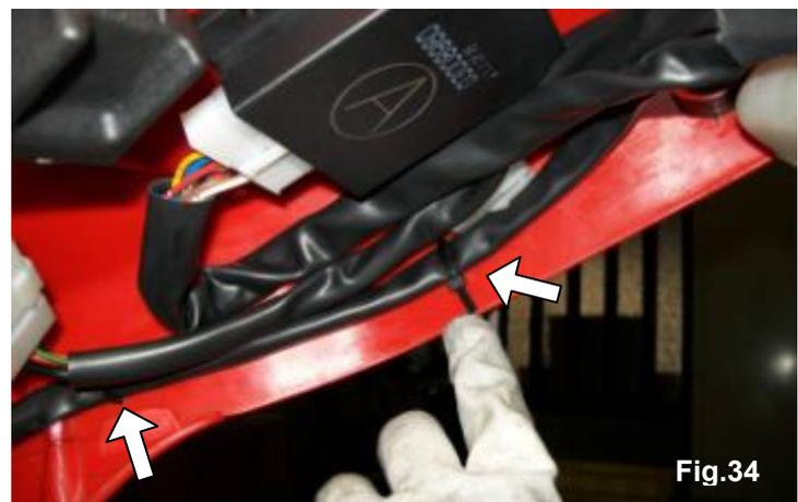
**3.8.16** ATTACH THE DUAL LOCK FIXING STRAP UNDER THE FRONT FAIRING (CLOSE TO THE BATTERY) AND PLACE THE FUSE HOLDER (SEE FIG. 35).
