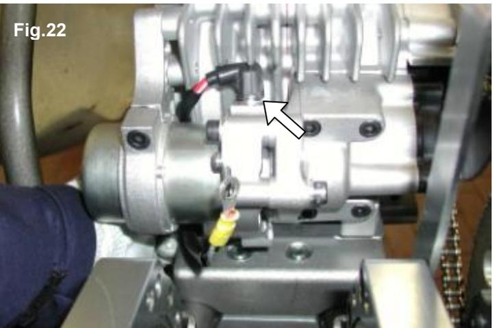
FIX THE HARNESS EYELET GROUND CABLE WITH THE EYELET TERMINAL TO THE STARTER SUPPORT, BY MEANS OF THE FIXING SCREW M6x35 (SEE FIG. 23).
