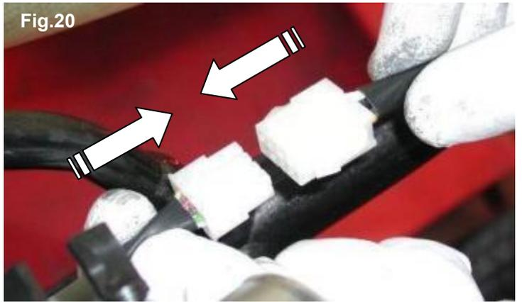
CONNECT THE ONE WAY TERMINAL FROM THE ELECTRIC STARTER WITH THE ONE WAY TERMINAL ON THE HARNESS
