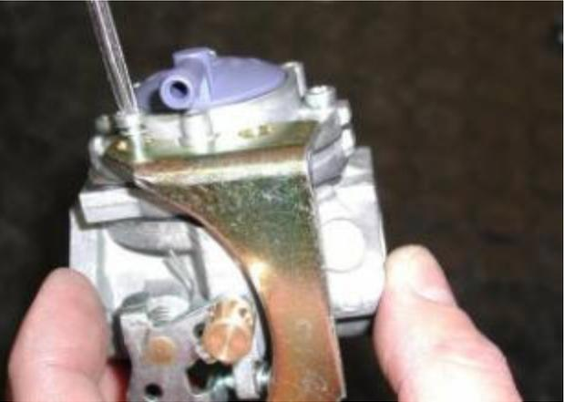
**3.5.4 INSTALL THE INTAKE SILENCER SUPPORT 2 SCREWS M5 X10 (SEE FIG. 7)**
