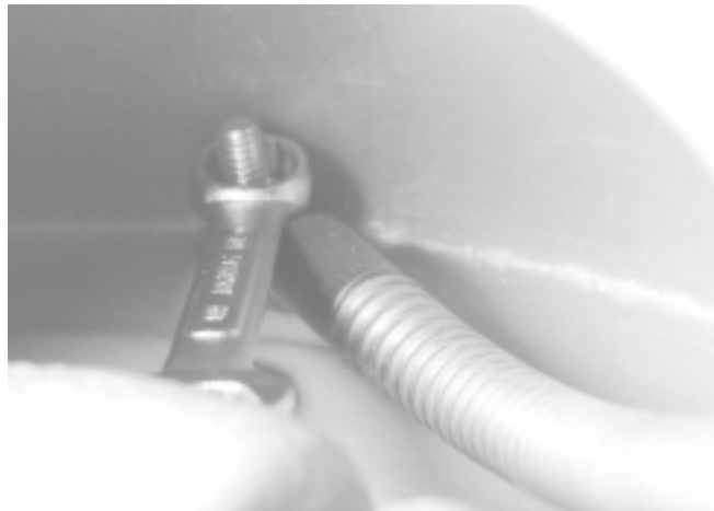
6. Enlevez le boulon de retenue du raccord flexible. Celui-ci est situé au dos du tambour (Figure 14).
