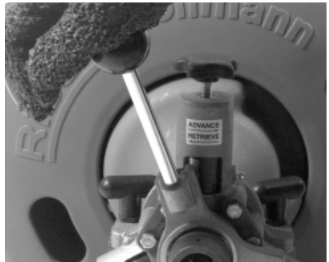
Figura 9 – Funcionamiento de la palanca de autoalimentación
