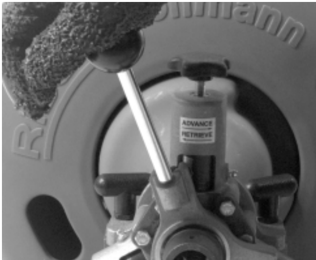
Figure 9 – Fonctionnement du levier d'avancement
