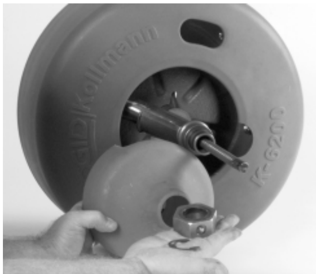
tuyau de guidage (Figure 13). Retirez le roulement de l'arbre.
