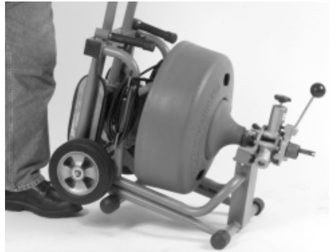
Figure 7 – Repliement de la béquille
