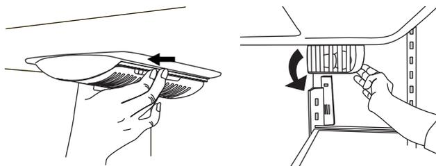
3. Remplacer la ou les ampoule(s) grillée(s) avec une ampoule ou (des) ampoule(s) pour appareil ménager ne dépassant pas 40 watts.
