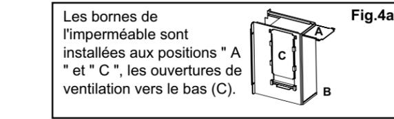
Les bornes de l'imperméable sont installées aux positions "A" et "C", les ouvertures de ventilation vers le bas (C).
