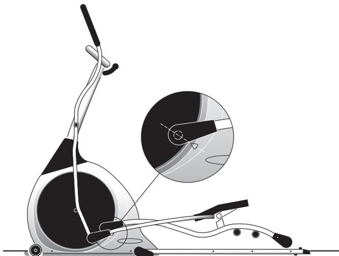
**ÉTAPE 2:** Lorsque l'axe de la pédale est aligné avec la flèche, soulevez la pédale et le rail simultanément. Assurez-vous que l'axe et la flèche reste alignée lors de cette étape. (A) Toujours en tenant la pédale, soulevez tranquillement le rail. Le système de fermeture situé sous la pédale devrait maintenant être aligné avec le mécanisme de fermeture située sur l'extrémité du rail. Insérez le mécanisme fermement dans le trou. (B).
