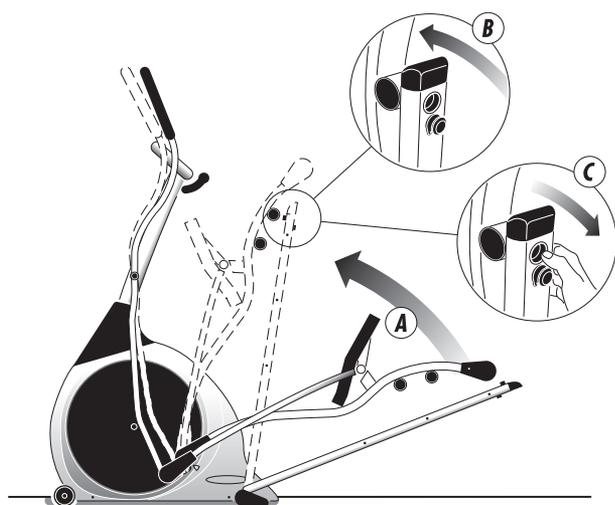
**ÉTAPE 3:** Pour déplier votre marcheur elliptique, appuyer sur le bouton intégré dans l'extrémité de chaque rail. (C) Reposer le rail sur le sol et par la suite la pédale.
