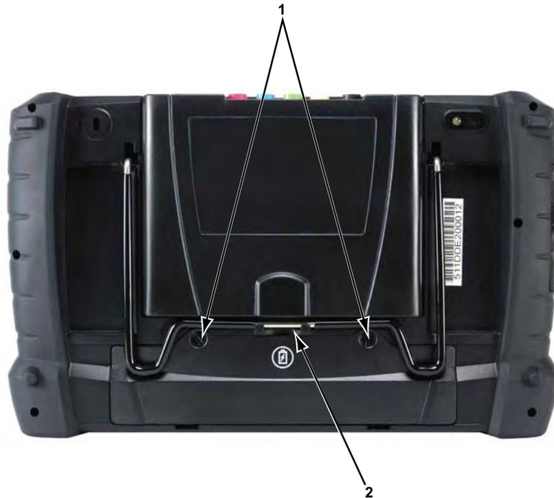
**1— Captive Screws****2— Lifting Recess**
