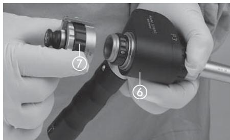
Dichtungskappe ⑦ durch  $\frac{1}{4}$  Umdrehung gegen Uhrzeigersinn lösen, abziehen.
