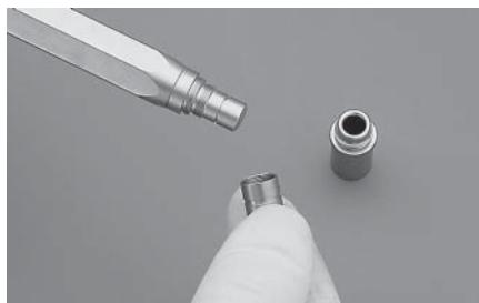
Beide Adapter vom Lichteinlaßstutzen entfernen, um ungehinderten Zugang zur Fiberfläche zu haben.
