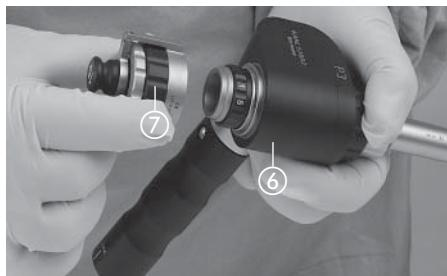
Dichtungskappe ⑦ (fixiert auch Gehäuse ⑥) aufsetzen und durch  $\frac{1}{4}$  Umdrehung im Uhrzeigersinn fixieren.
