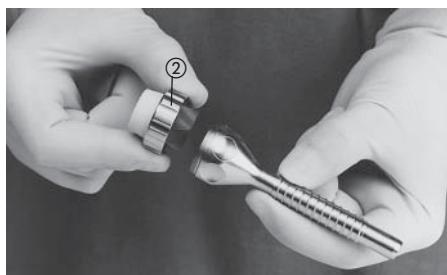
Zum Entfernen des Silikonlippenventsils ① Rändelring ② abschrauben. Silikonlippenventil herausnehmen, auf Beschädigung prüfen und ggf. austauschen.
