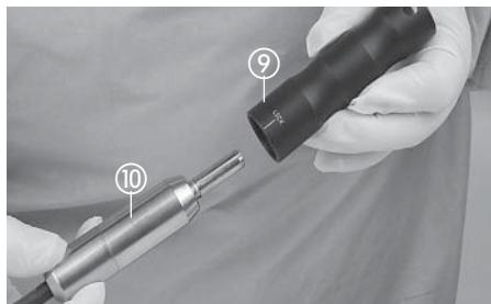
Handgriff ⑨ über EC-Motor mit Anschlusskabel ⑩ schieben
