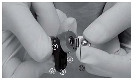
Der Ventilkopf (2) kann weiter zerlegt werden, um die kleine Dichtungskappe, den Stöbel (4) oder die innenliegende Dichtung (10) auszutauschen. Hierzu Schieber (5) am Hebel (6) des Ventilkopfes (2) nach außen ziehen.
