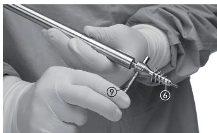
Spiraleinsatz (6) mit Hilfe des Schlüssels (9) lösen und abnehmen.
