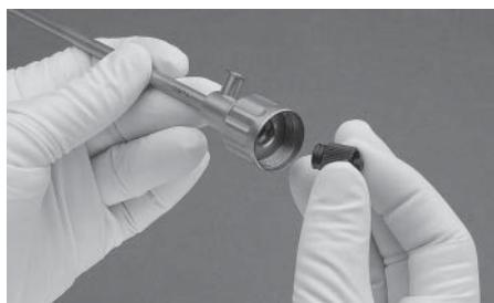
Spezielle LUER-Lock-Verschlusskappe (Art.-Nr. 6225895) von Aussenschacht lösen.
