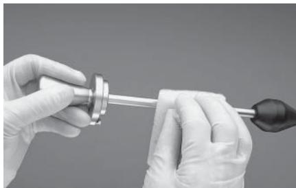
Obturator mit desinfiziertem Schwamm oder Bürste reinigen, anschließend spülen und trocknen. Kunststoffspitze auf Beschädigungen prüfen. Bei Beschädigungen darf der Obturator nicht mehr verwendet werden.
