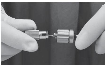
Reinigungsadapter 26166 LL auf den Zangenaufsatz aufschieben; er rastet automatisch ein. Dabei darauf achten, dass die Nase des Zangenaufsatzes mit dem Schlitz des Reinigungsadapters zur Deckung kommt.
