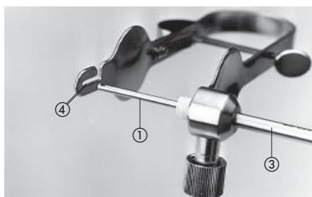
Die Einfrässungen am hinteren Ende des Innenteiles ① in die richtige Stellung bringen, um in die L-förmige Einfrässung ④ am Handgriff zu gleiten.
