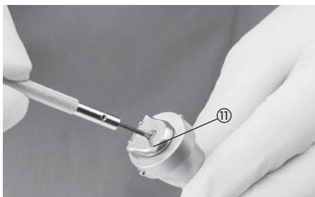
Hierzu ist die Schraube (11) über der Dichtung (10) im Uhrzeigersinn (Linksgewinde) aufzudrehen.
