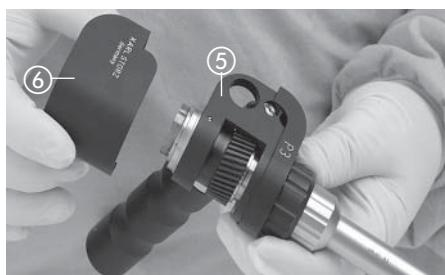
Gehäuse ⑥ aufsetzen.
