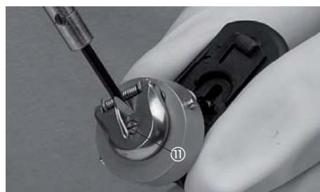
Die innenliegende Dichtung (10) auf Beschädigung prüfen, ggf. austauschen. Hierzu Schraube (11) über der Dichtung im Uhrzeigersinn (Linksgewinde) aufdrehen.
