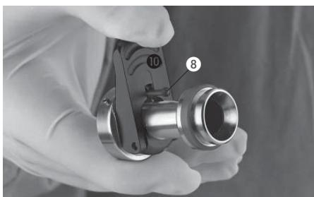
Daumenplatte **10** nach unten gedrückt halten und Stößel **8** nach hinten entnehmen.
