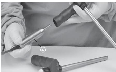
Motor ④ einschieben, bis dieser mit hörbarem Klick einrastet.
