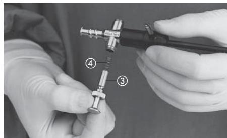
Feder ④ aus dem Kolben nehmen.
