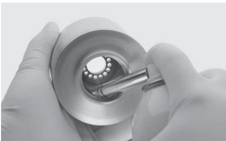
Vor jeder Sterilisation muss der Hohlwellen-Motor mit Universal-Spray behandelt werden (siehe Zubehör). Dazu den Hohlwellen-Motor beidseitig nacheinander an den Sprühschlitten auf den Spray-Einsatz aufsetzen und ca. 1 s je Seite einsprühen.
