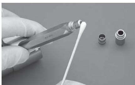
Die Fiberflächen sowie die optischen Endflächen können nach der manuellen sowie maschinellen Reinigung mit Alkohol nachgetrocknet werden.
