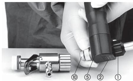
Rändelschraube ⑩ lösen (Drehung im Gegenzeigersinn). Das Messer kann jetzt nach hinten herausgezogen werden.
