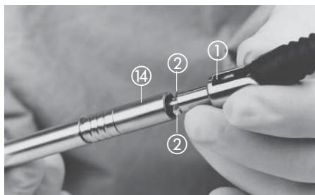
Einsatz ① mit der kugelförmigen Seite in das Bajonet des Schafes ⑯ einführen.
