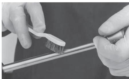
Sämtliche Außenflächen mit einem desinfizierten Schwamm oder einer Bürste reinigen.
