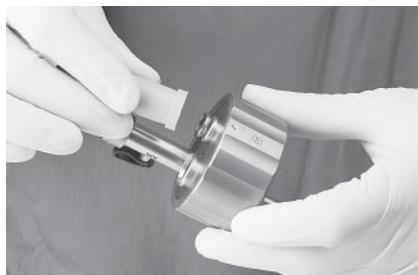
Dichtungskappen abnehmen, auf Beschädigung prüfen, ggf. austauschen.
