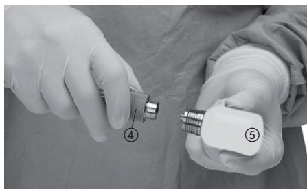
Eine der Glocken ⑤ mit Hilfe der Überwurfmutter ④ an den Handgriff ② schrauben. Darauf achten, dass die an der Glocke angebrachte Nase in die Nut am Handgriff eingreift.
