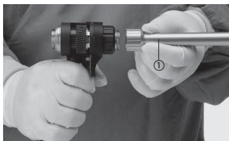
Außenrohr ① anschrauben und fest anziehen.
