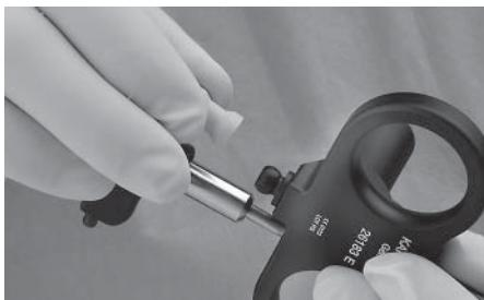
Gummidichtung abnehmen. Auf Beschädigung überprüfen, ggf. austauschen.
