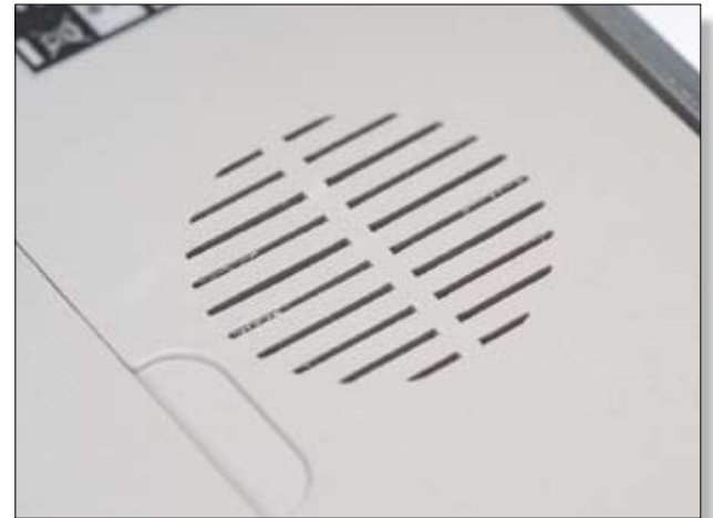
Fan vent grill.
