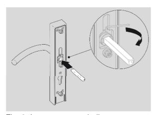
Fig. 2: Insert square spindle
