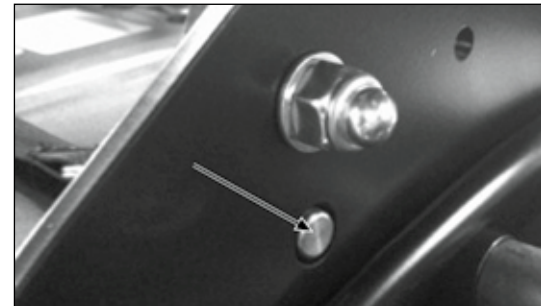
Abb. 11b Verriegelungsbolzen, eingerastet
