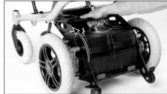
Abb. 10 Sichern der Akkupacks
