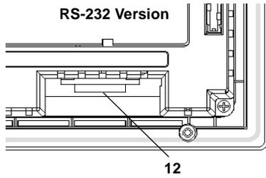
Remote I/O, DH+, DeviceNet, ControlNet or DF1 Version with RS-232 Port
