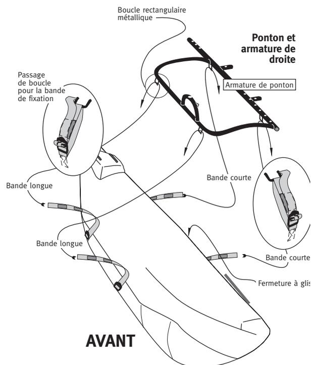
À présent, attachez les deux sangles intérieures et les deux sangles extérieures du ponton à l'armature du ponton. Enfilez les sangles de la façon suivante:
