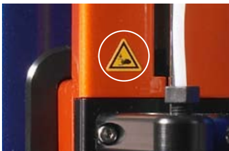
Figure 1.2 Le symbole d'avertissement entouré d'un cercle blanc indique un « risque d'écrasement et de cisaillement ».
