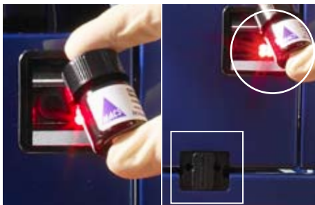
Figure 1.3 Position des lasers. Les lasers invisibles de détection de râteliers sont situés dans la zone rectangulaire. Le lecteur de code 2D (visible) est entouré d'un cercle blanc.
