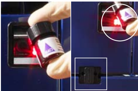
Figure 1.3 Position von Lasern. Im Bereich des Rechtecks befinden sich verdeckt montierte Laser zur Erkennung von Gestellen. Der (sichtbare) 2D-Barcodeleser ist hier mit einem Kreis gekennzeichnet.
