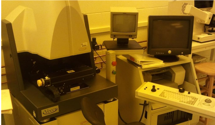
Figure 34 - Veeco Wyko NT 3300 Optical Profilometer
