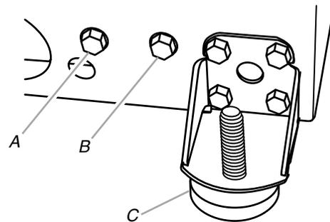
A. Vis de réglage des roulettes arrière
