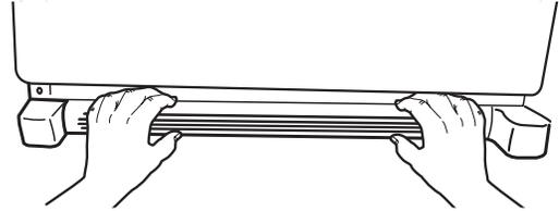
2. Soulever ou abaisser la caisse. À l'aide d'un tournevis à tête hexagonale de  $\frac{3}{8}$ " , tourner les vis de réglage de chaque côté pour soulever ou abaisser ce côté du réfrigérateur.
