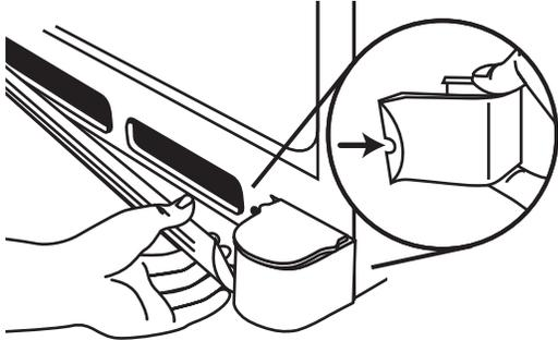
3. À l'aide d'un tournevis ou d'un tournevis à tête hexagonale de  $\frac{3}{8}$ " , tourner la vis de réglage des roulettes de chaque côté pour soulever ou abaisser ce côté du réfrigérateur.
