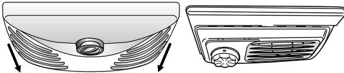
3. Remplacer la ou les ampoule(s) grillée(s) avec une ampoule électrique pour appareil ménager de pas plus de 40 watts.
