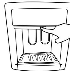
Le robinet pivote automatiquement vers le centre. Cependant, il est nécessaire de le faire pivoter manuellement pour le ramener à sa position initiale. Lorsqu'il est en place, un clic est émis.
