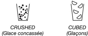
Pour de la glace concassée, les glaçons sont concassés avant d'être distribués. Cette action peut causer un court délai lors de la distribution de glace concassée. Le bruit du broyeur de glaçons est normal et la dimension des morceaux de glace peut varier. Lorsqu'on passe du mode glace concassée au mode glaçons, quelques onces de glace concassée sont distribuées avec les premiers glaçons.
