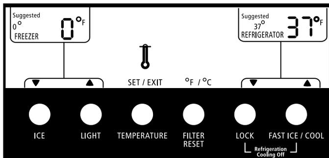
**REMARQUE :** Pour visualiser les températures en Celsius, appuyer sur la touche FILTER (filtre) lorsque le mode de réglage est activé. Pour revenir au mode d'affichage en Fahrenheit, appuyer de nouveau sur FILTER.
