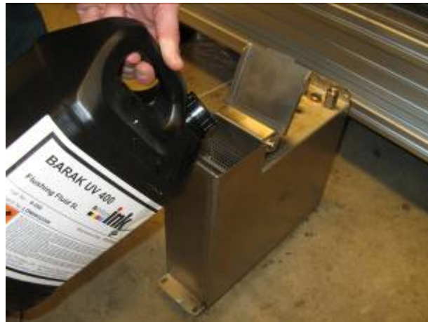
Figure 2: Pouring flushing fluid into the MIT
