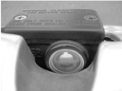
3.BRAKE OIL IF NECESSARY.(USING FMVSS DOT 3 OR SAE J1703 BRAKE OIL)
