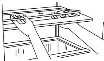
3. Replacer le cadre du couvercle du tiroir à viande dans les supports sur les parois latérales du réfrigérateur et abaisser le devant du cadre du couvercle en place.
