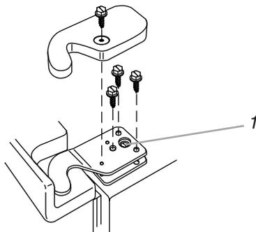
5. Enlever la charnière inférieure si nécessaire. Les deux charnières inférieures ont une construction semblable. **NE PAS ENLEVER LA VIS 1 TEL QU'ILLUSTRÉ DANS LE SCHÉMA.**
