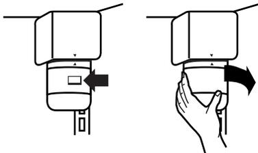
3. Aligner la marque "INSTALL" de l'étiquette du filtre avec le repère moulé dans le couvercle du support de montage du filtre. Introduire la cartouche du filtre dans la tête. Pousser la cartouche dans la monture du filtre. Visser la cartouche un quart de tour à droite pour la verrouiller en place. La marque "REMOVE" devrait être alignée avec le repère sur le couvercle avant.
