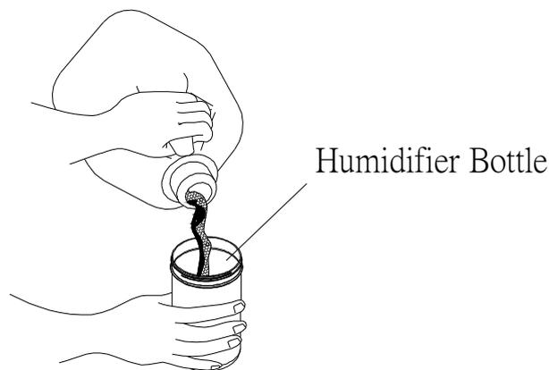
FIGURE 1 — FILLING THE HUMIDIFIER
