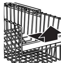
3. Replacer le panier en le plaçant sur les glissières sur la paroi latérale. Soulever légèrement le devant du panier en le poussant au-delà des butées de la glissière et glisser le panier jusqu'au fond.
