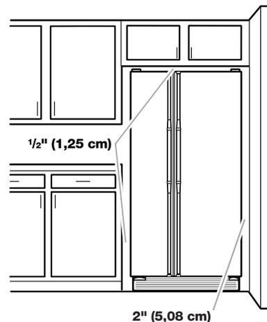
**REMARQUE :** Ne pas installer le réfrigérateur près d'un four, d'un radiateur ou d'une autre source de chaleur, ni dans un endroit où la température baissera au-dessous de 55°F (13°C).
