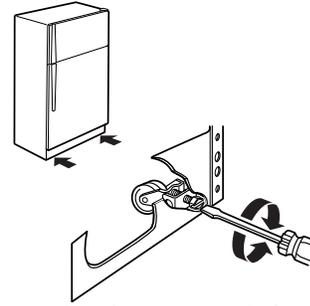
3. Ouvrir les deux portes de nouveau et s'assurer qu'elles se ferment aussi facilement que vous le désirez. Sinon, incliner le réfrigérateur un peu plus vers l'arrière en tournant les deux vis de nivellement vers la droite. Plusieurs tours peuvent être nécessaires et vous devez tourner les deux vis de nivellement d'un espace égal.
