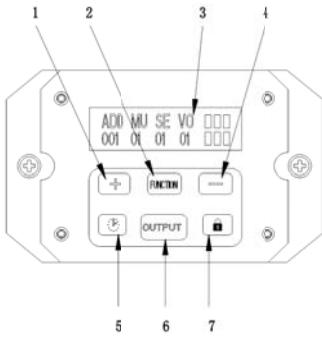
Stecken Sie die Fernbedienung auf der Rückseite der Nebelmaschine. Wenn die Nebelmaschine an das Netz verbunden und eingeschaltet worden ist, leuchtet den Hauptschalter, um anzuseigen, dass die Nebelmaschine mit Strom versorgt wird. Der Balken unten der HEAT-Anzeige blinkt. Nach einer Aufheizzeit von ± 5 Minuten verschwindet der Balken; OK erscheint, um anzuseigen, dass die Nebelmaschine fertig ist.
