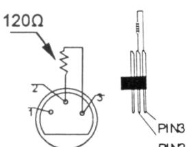
Ein DMX-Abschlusswiderstand ist empfehlenswert für Installationen, bei denen das DMX-Kabel lang ist oder in einer Umgebung mit vielem elektrischem Rauschen (z.B. Discos). Der Abschlusswiderstand verhindert Störung des digitalen Steuersignals durch elektrisches Rauschen. Der DMX-Abschlusswiderstand ist nur eine XLR-Buchse mit einem 120Ω Widerstand zwischen 2 und 3, die den XLR-Ausgang des letzten Geräts in der Kette angeschlossen wird.
