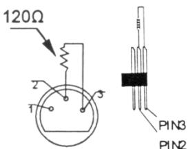
Een DMX terminator is aanbevolen als de DMX kabel vrij lang is of wordt gebruikt in een omgeving met veel elektrische ruis (vb. een discotheek). De terminator voorkomt corruptie van het digitale controlesignaal door elektrische ruis. De DMX terminator is niets meer dan een XLR plug met een weerstand van  $120\Omega$  van pin 2 naar 3. Deze XLR plug wordt dan aangesloten op de XLR uitgang van het laatste toestel in de reeks.
