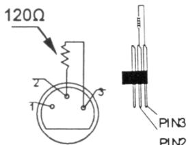
Une terminaison DMX est à recommander si le câble DMX doit couvrir une grande distance ou s'il est utilisé dans un environnement avec beaucoup de bruit électrique (ex. un discothèque). La terminaison prévient la corruption du signal de contrôle numérique par le bruit électrique. La terminaison DMX n'est rien qu'une fiche XLR avec une résistance de 120Ω de broche 2 vers broche 3 (voir illustration à gauche). Cette fiche XLR est connectée à la sortie XLR du dernier appareil de la série.
