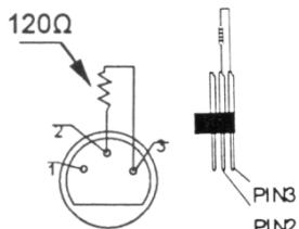
Se recomienda una terminación si el cable DMX debe cubrir una gran distancia o si se usa en un medio ambiente con mucho ruido eléctrico (ej. una discoteca). La terminación impide que el ruido eléctrico corrompa la señal de control numérico. La terminación DMX no es más que un conector XLR con una resistencia de 120Ω de polo 2 a polo 3 (véase figura a la izquierda). Este conector XLR está conectado a la salida XLR del último aparato de la serie.
