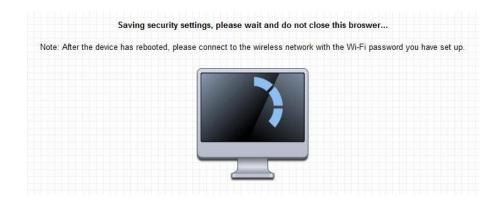
7. Khi màn hình sau xuất hiện, thiết bị đã hoàn tất quá trình khởi động của nó. Kết nối lại với bộ định tuyến du lịch bằng cách tìm kiếm mạng không dây có sẵn với "tên thiết bị" và "khóa bảo mật" mà bạn đã thiết lập ở bước 5 (thiết lập của bạn được hiển thị trên màn hình máy tính như trong mũi tên).
