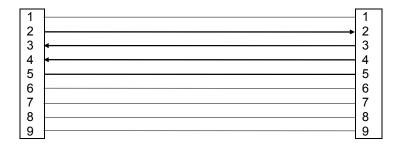
Not Used - optional Receive Data Transmit Data DTR Signal Ground Not Used - optional Not Used - optional Not Used - optional Not Used - optional Not Used - optional
