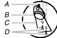
A. Bottom hinge pin B. Leveling leg C. Bottom hinge D. 5/16" screws
