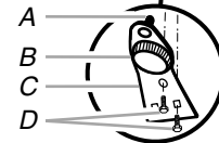
A. Axe de la charnière inférieure B. Pied de nivellement C. Charnière inférieure D. Vis de \frac{5}{16} "
