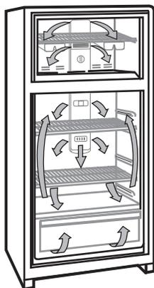
Ne pas obstruer l'une ou l'autre de ces ouvertures d'aération avec des aliments emballés. Si les ouvertures d'aération sont bloquées, le courant d'air sera coupé et des problèmes de température et d'humidité peuvent survenir.
