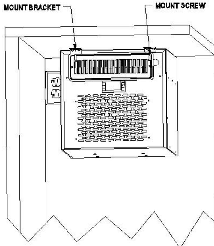
**Fig. 2.6 FASTENING BRACKET & SCREW**
