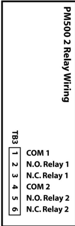
**Figure 2; 2 Relay outputs wiring diagram**
